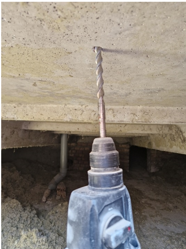
Fot. nr 8. Pomiar grubości płyt prefabrykowanych – 4,5cm.
