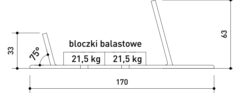
PODPORA TYP P2 (skala 1:20)
